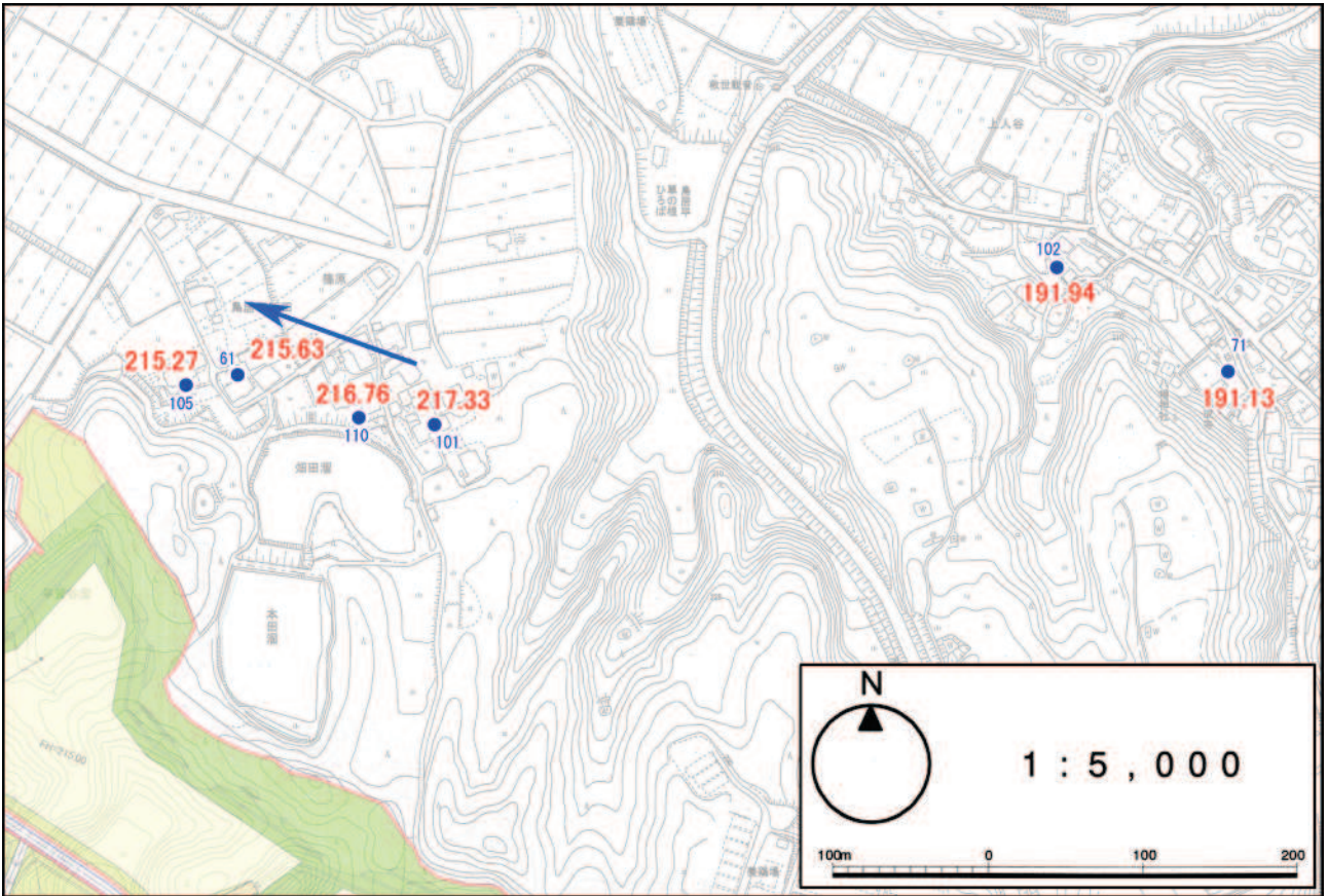
図 7 - 7 - 5 地下水の流水方向推定図 (鳥居平)
