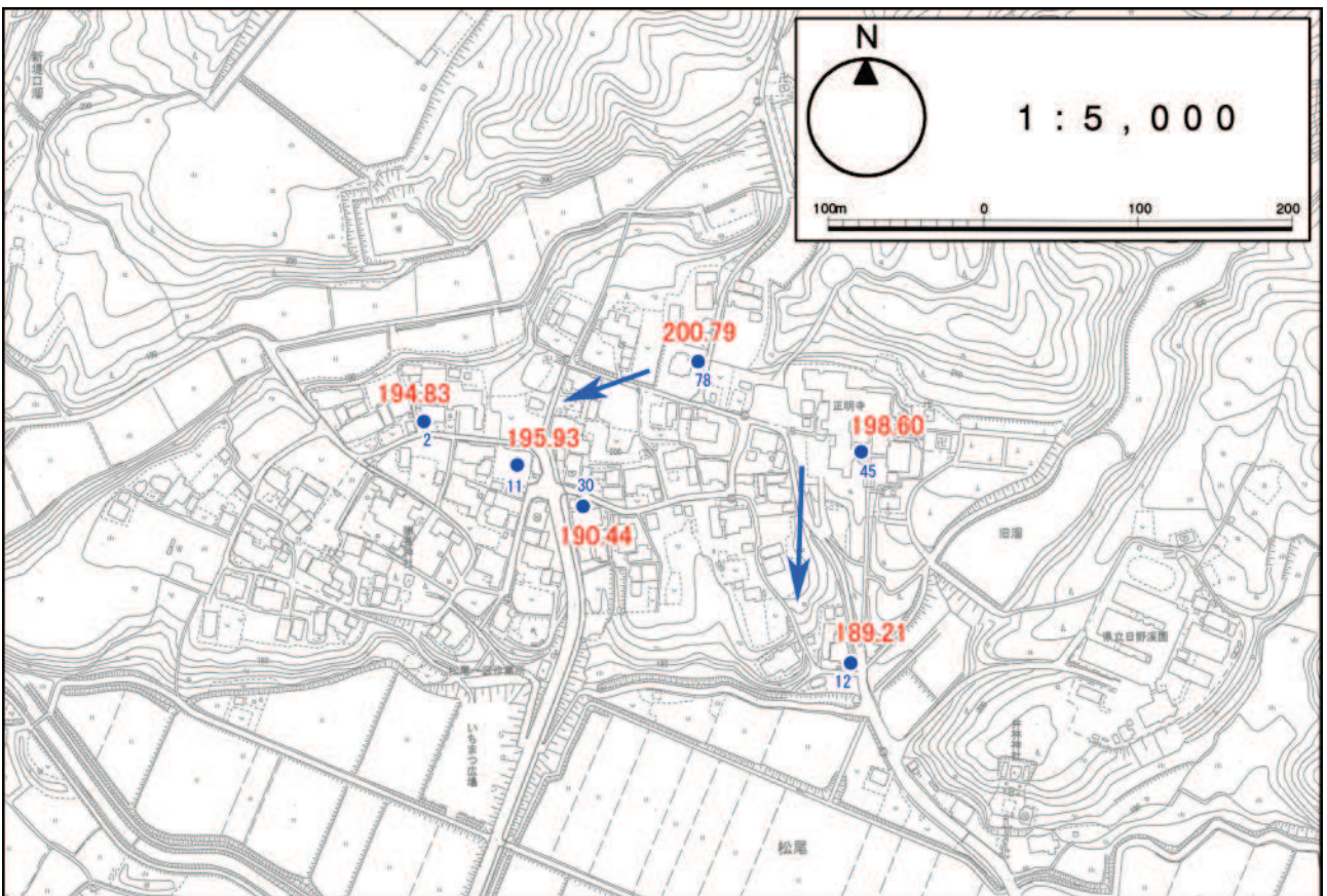
図 7 - 7 - 5 地下水の流水方向推定図 (松尾1区)
